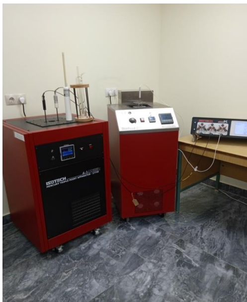
Նկ. 1 Մնդիկի եռակի կետի պահպանման ջերմաստիճանային թերմոստատ ISOTECH 17725
