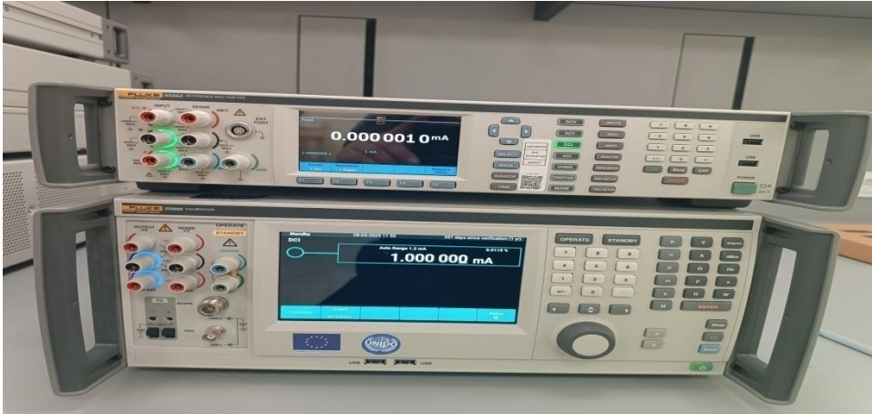
Նկ. Բարձր ճշգրտության թվային էտալոնային մուլտիմետր REFERENCE MULTIMETER 8.5FLUKE 8588A
